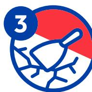
Resane pequeñas grietas, fisuras e irregularidades con Cemex Cemento Plástico utilizando espátula. Deje secar de 1 a 3 horas\*
