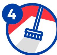
Aplique la primera capa de Cemex Impermeabilizante Acrílico sin diluir, sobre toda la superficie en un solo sentido, usando un cepillo de ixtle. La malla de refuerzo se coloca solo sobre puntos críticos. Se recomienda dejar secar de 4 a 6 horas\*.
